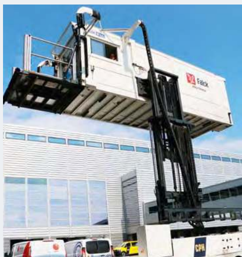
Den østrigsk byggede Bulmor Ambulift kan løfte kassen op i 5,70 meters højde. Den kan også sænke kassen ned på siden og helt ned i "gulvhøjde", hvis mange skal med på én gang.
