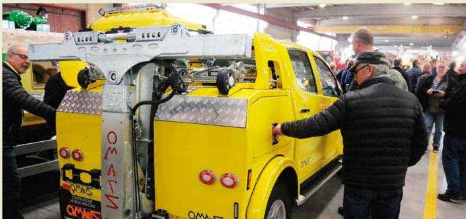
Denne lille 3.500 kg grillvogn, typisk bygget på en Isuzu, er en stor sællert for Omars, der skærer hele bagenden af og monterer deres eget modul. Falck har også bestilt en håndfuld af de fikse "P-hus bjærgere" med en højde på knap 1,80 meter, og efter en langvarig dialog med myndighederne er det netop lykkedes at få den første indregistreret.
